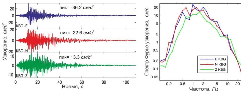
Рис. 9. Три компоненты записи ускорения грунта на станции «Крутоберегово» (KBG) от землетрясения 20 февраля в 21<sup>h</sup>43<sup>m</sup> с  $K_S=14.1$  и сглаженные амплитудные спектры Фурье этих записей
