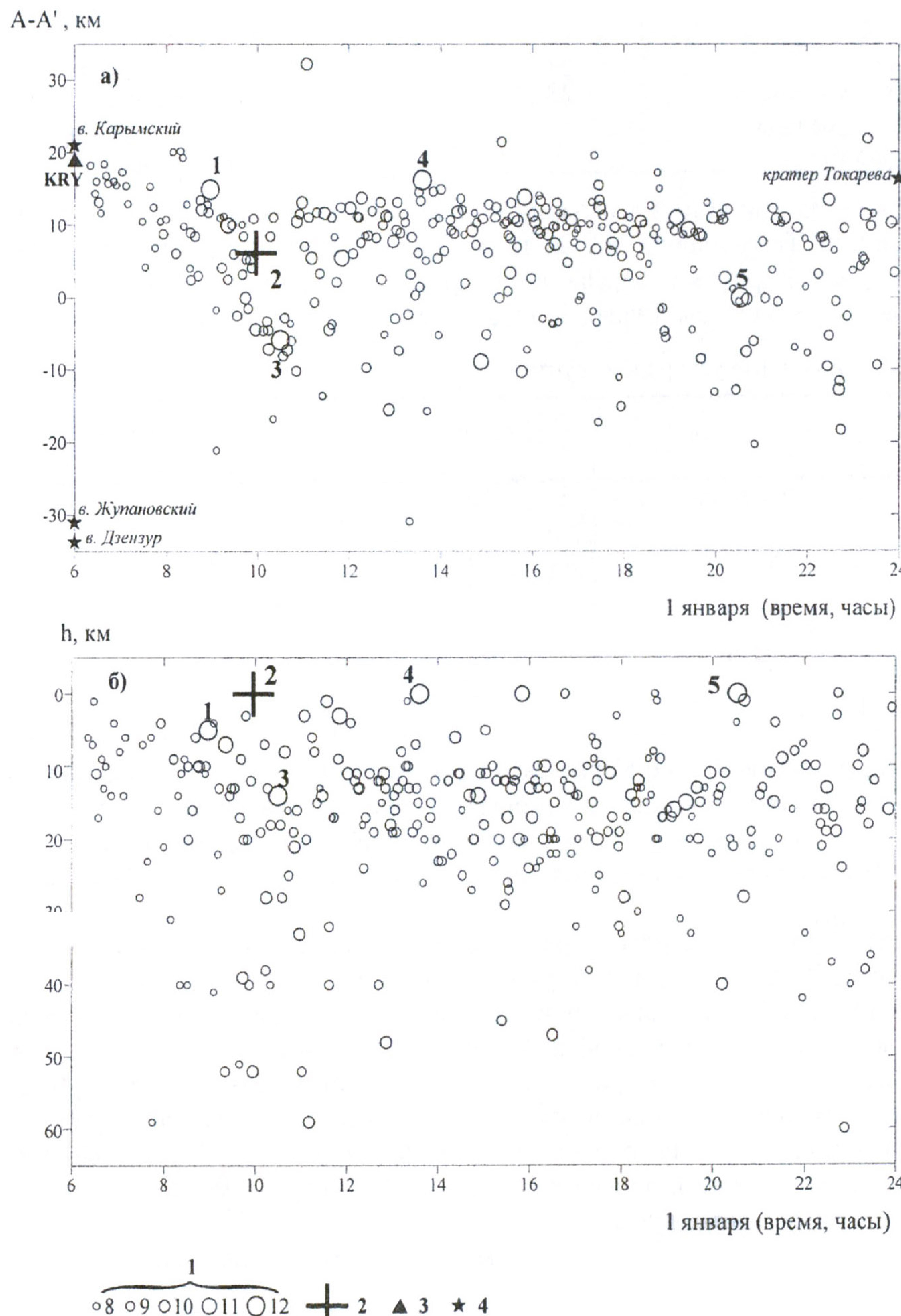
**Рис. 5.** Пространственно-временное распределение форшоков и афтершоков Карымского землетрясения за один день (1 января): а – в плане по линии А-А' (на рис. 3), б – по глубине
